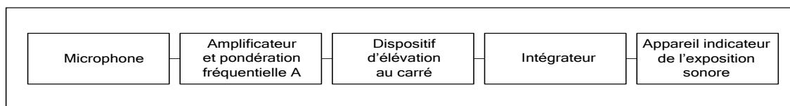
Diagramme fonctionnel d'un exposimètre de bruit adapté de la norme CEI-61252, Édition 1.1 (2002-03)
