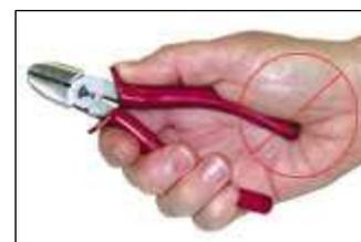
Figure 11 : Compression des tissus de la paume causée par une poignée trop courte<sup>③</sup>
