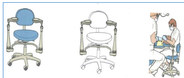
Figure 12 : Exemple de chaise avec appuis-coude permettant l'adoption d'une posture idéale pour la travailleuse. 3
